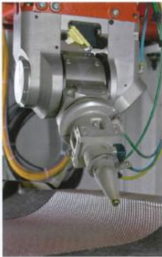
Der Roboter des 6-Achs-Lasersystems im Einsatz an einer 3D-Form aus der Automobilindustrie.
