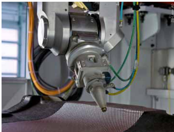
Der Roboter des 6-Achs-Lasersystems im Einsatz an einer 3D-Form aus der Automobilindustrie.
