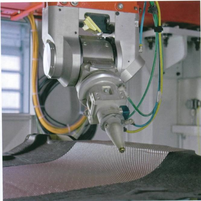
Bild 3: Der Roboter des 6-Achs-Lasersystems im Einsatz an einer 3D-Form aus der Automobilindustrie.
