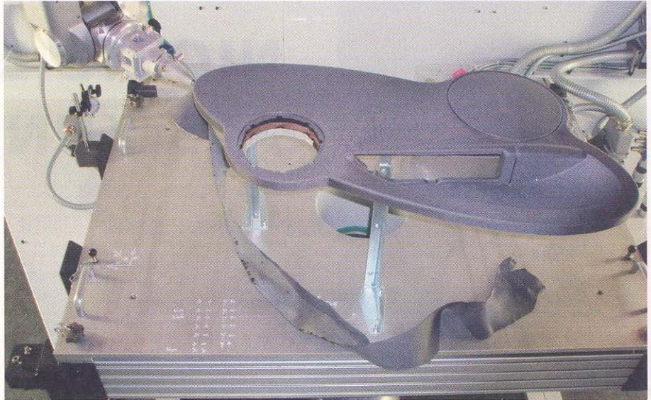
Der 3D-Laserroboter bei der Arbeit an einem hinterspritzten Teil.
